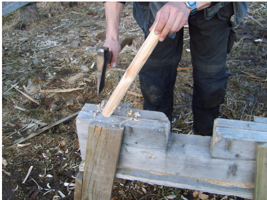
40. Hugg till en dubb, med fördel asymmetriskt. Lokala traditioner har gjort att olika träslag använts, själv brukar jag använda kärnfuru, men även gran, en och ek förekommer.
